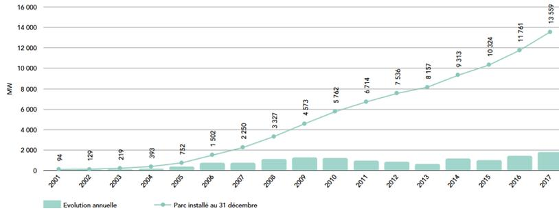
**Figure 10.3:** Évolution à la hausse de la puissance éolienne raccordée au réseau français de 2001 à 2017 (source : bilan électrique 2017 RTE)
