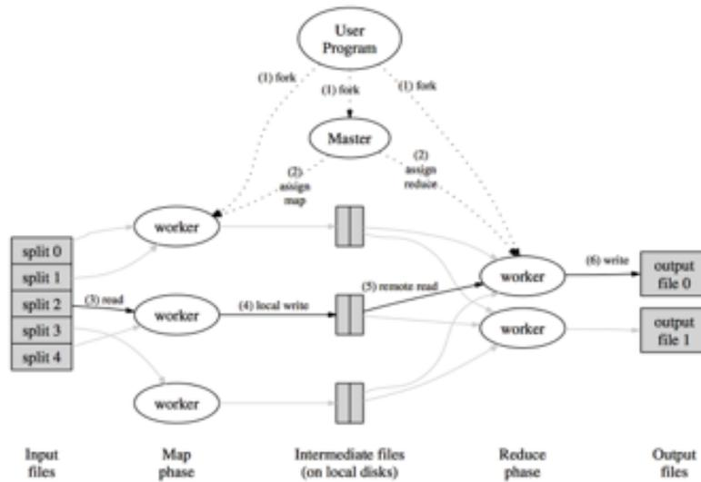
FIGURE 3.3: Schéma de principe du processus *MapReduce*
